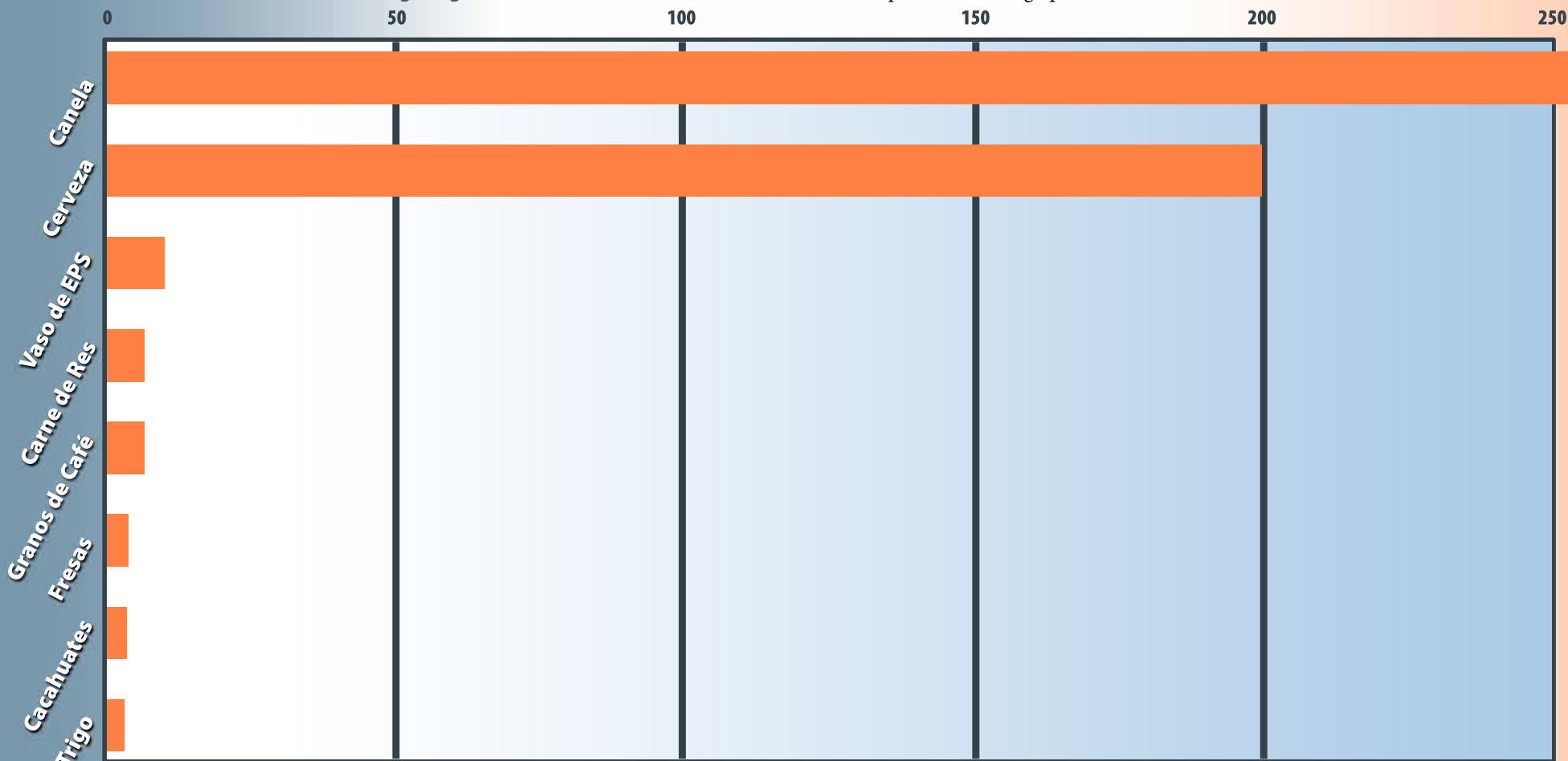
Figura 2 Estireno en Alimentos Selectos y Migración de Vaso de Poliestireno Expandido (Partes Por Billón)
